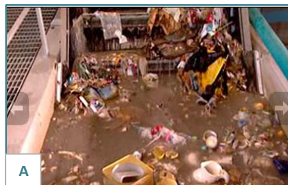
Instalacja ArrowBio: a) zbiornik hydroseparacji b) zbiorniki fermentacji metanowej
