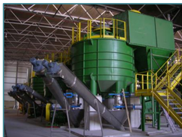
Instalacja BTA International GmbH (zdjęcie ze strony producenta) - pulper
