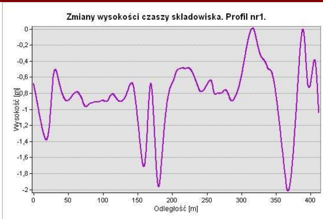
Wykres 2 . Zmiany wysokości czaszy składowiska, profil 1- rozkład wartości.
