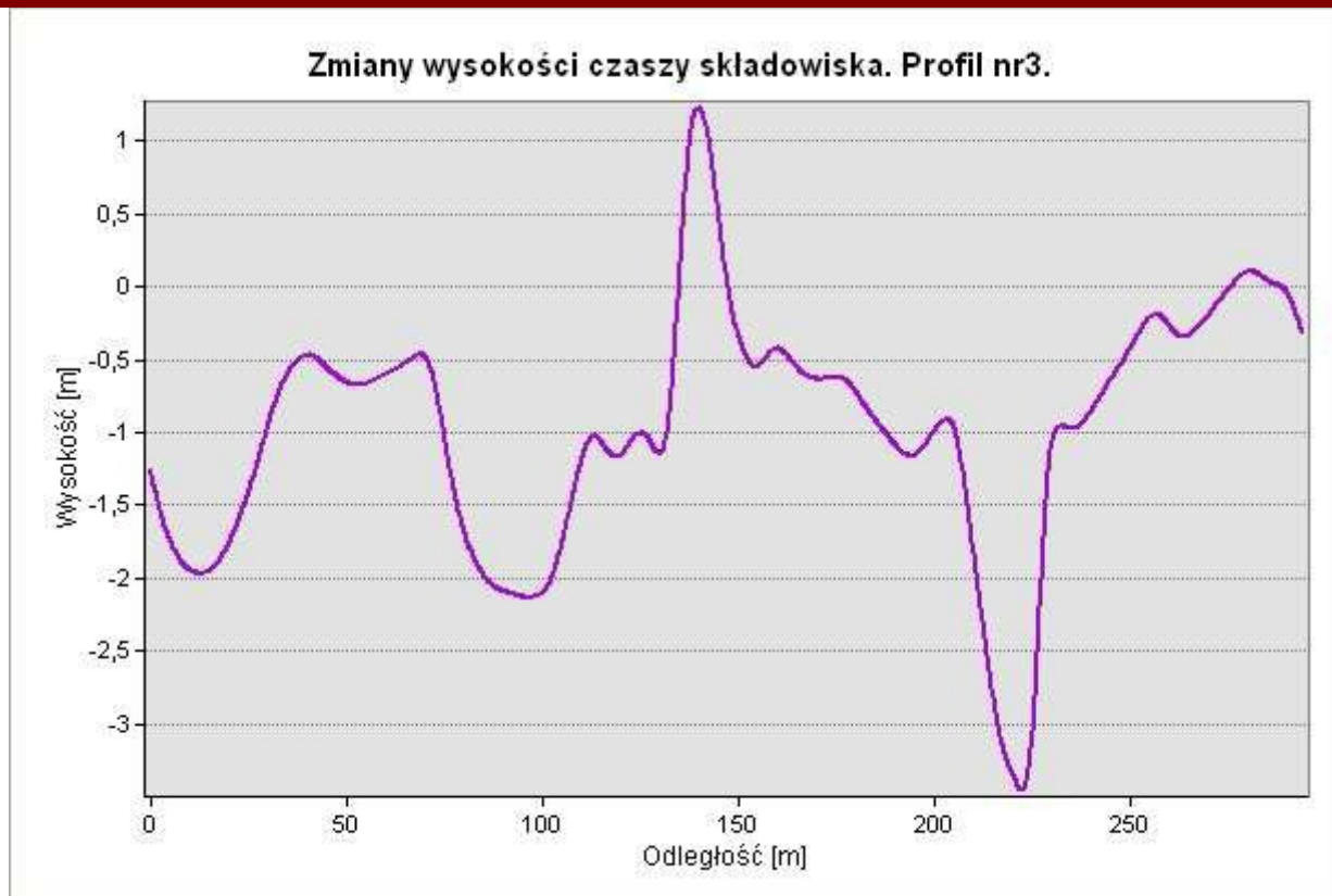
Wykres 6. Zmiany wysokości czasy składowiska, profil 3- rozkład wartości.
