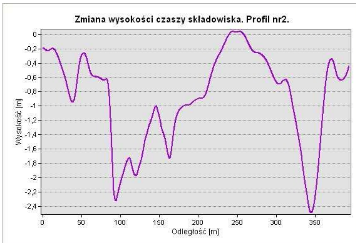
Wykres 4. Zmiany wysokości czaszy składowiska, profil 2- rozkład wartości.
